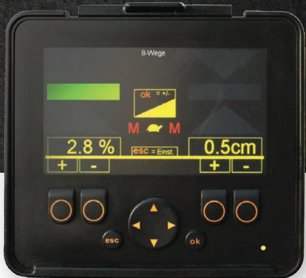
In einem Untermenü wird die Geschwindigkeit der Hydraulik Zylinder für die jeweilige Arbeitssituation eingestellt.
