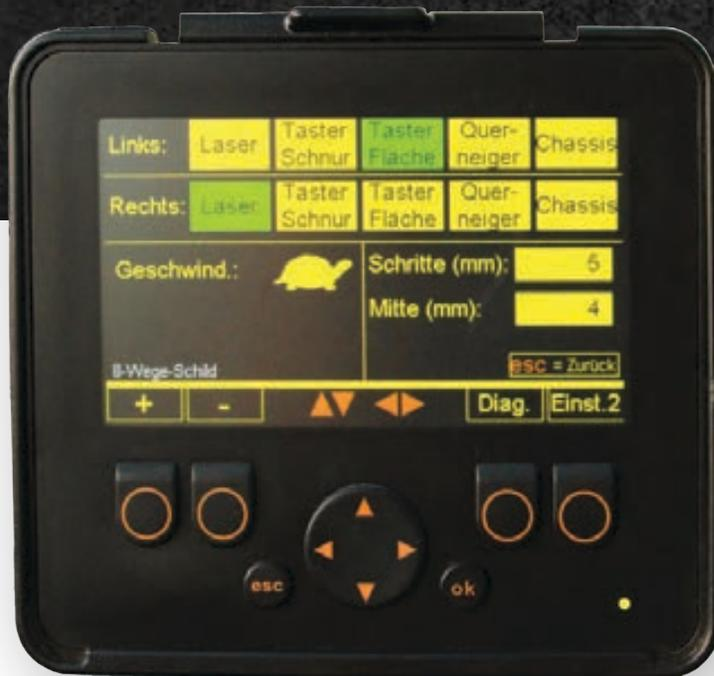
zur Anzeige der 4 automatischen Steuerungsarten in der Kabine
