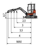
Hebekraft basierend auf ISO-Norm 10567 und überschreitet nicht mehr als 75% der Kipplast oder 87% der hydraulischen Hebe-Kapazität der Maschine.
