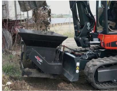
Befüllen mit der Baggerschaufel
