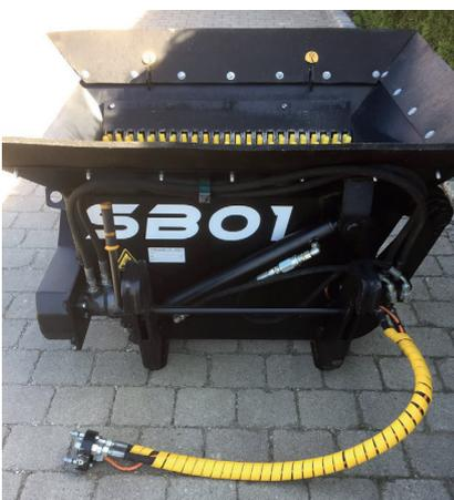
Aufnahme, Verriegelung und Multikupplung an der Siebanlage SB01
