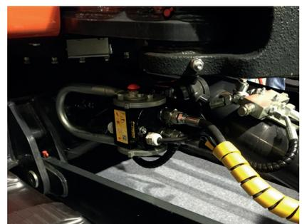
Fast-Multikupplung am Unterwagen des Baggers zur Energieversorgung der Siebanlage
