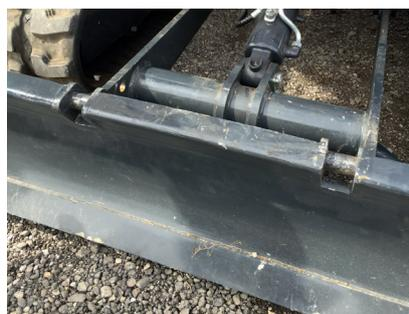
Aufnahmeösen am Frontschild des Baggers für die RSB *SIDE WORKS*-Anbaugeräte
