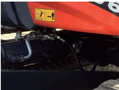
Zusätzlicher Hydraulikkreis am Bagger
