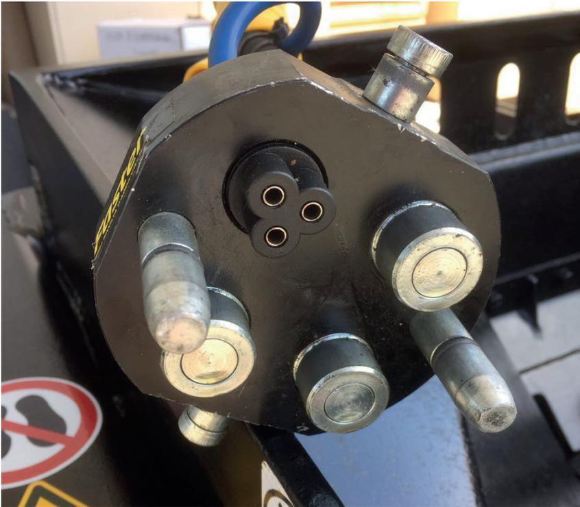
Stecker am Anbaugerät mit Hydraulikanschlüssen,
