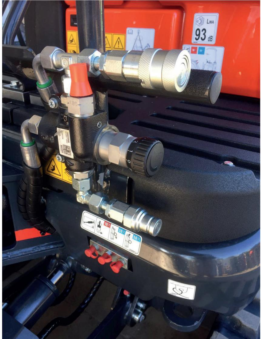
Hydrauliknebenabtrieb zum Anschluss der Hycon-Werkzeuge mit Hydraulik Vor- und Rücklauf sowie Durchflussregelung
