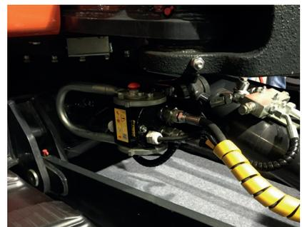
Fast-Multikupplung am Unterwagen des Baggers zur Energieversorgung des Graders
