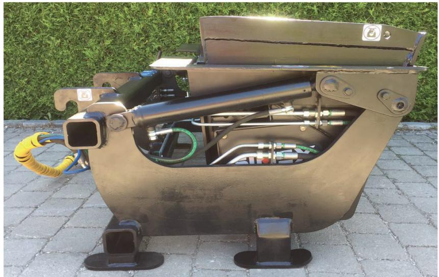
Hohe Kraft an den Zähnen durch Radialkolbenmotoren direkt an der Brecherwelle
