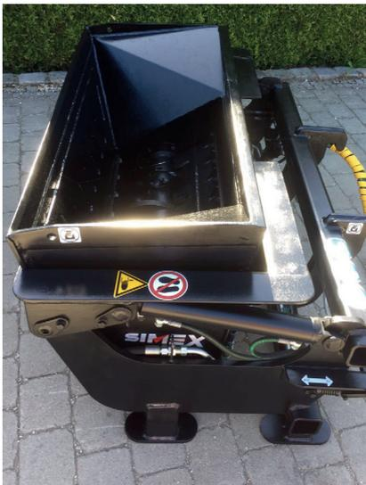
Kurzzeitige Drehrichtungsumkehr zum Freifahren der Welle bei verkantetem Material
