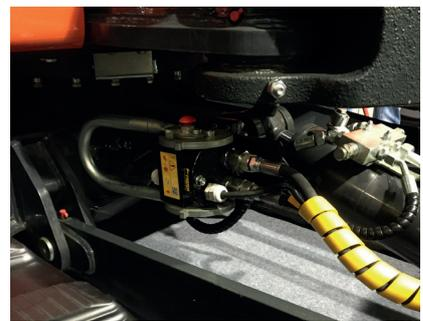
Faster-Multikupplung am Unterwagen des Baggers zur Energieversorgung der Brecheranlage
